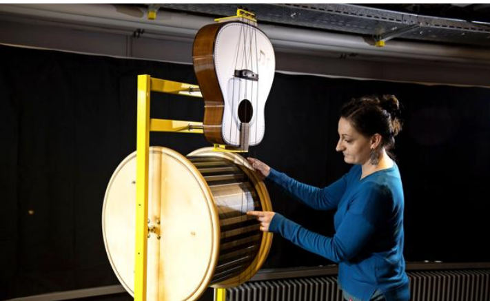
Grâce à un effet d'optique, créé par des lignes blanches peintes sur le cylindre qui tourne, on perçoit la vibration des cordes placées devant, des vaguelettes d'ordinaire invisibles à l'œil nu.
