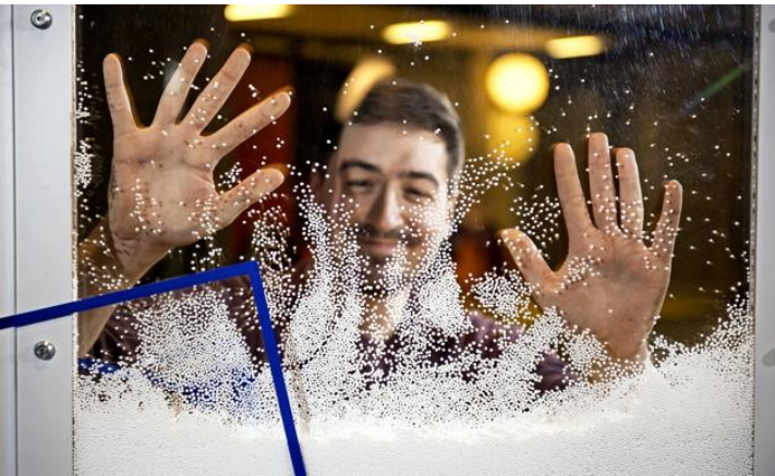
En frottant la paroi de plexiglas, on peut bouger les billes de sagex sans les toucher: elles se chargent en électricité suite au frottement et attirent ou repoussent d'autres objets chargés.
