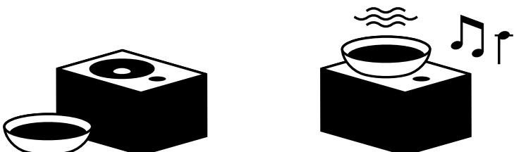
Une autre expérience consiste à placer sur un haut-parleur une coupelle dans laquelle on a mis un peu d'eau. On observe que les vibrations du haut-parleur se transmettent à l'eau et cela forme des vaguelettes et des mouvements à la surface de l'eau.
